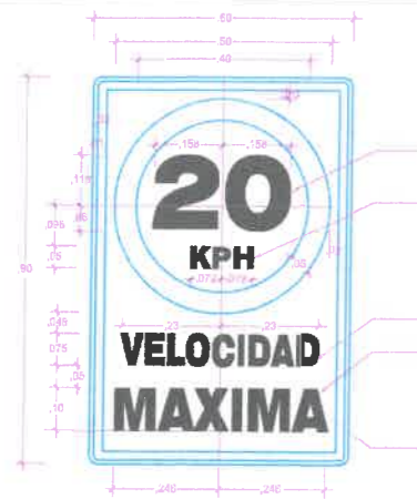
SEÑAL 4 (RESTRICTIVA) VELOCIDAD MÁXIMA ESC.: 1/10 R-30
