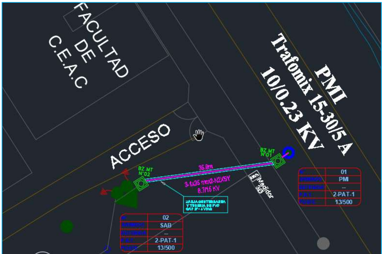
Instalación de BZ MT 01 y BZ MT 02, Zanja y Tubería de PVC SAP 3", cable de energía tipo N2XSY, 8.7/15 KV, de 3x1x35mm2
